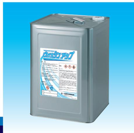
インキローラー色替え洗浄剤「カラーウォッシュ」の粘度を高くし、姉妹品として『ウォッシュアップ』を製品化したしました。粘度を高めたことにより、色替え時におけるインキローラー上での滞留時間が長くなり、インキ以外の紙粉や給湿液成分などの親水性物質を落とす効果が高まります。エマルジョン型洗浄剤の中でも水の配合率を高めてあり、より紙粉の除去に効果を発揮します。特に色替えを頻繁に繰り返す校正機などにお奨めできる製品です。
