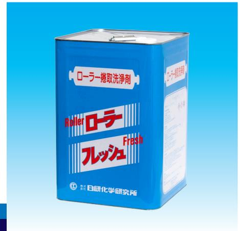
インキローラーの色替え洗浄において、インキ以外の紙粉や給湿液成分などの親水性物質がローラー上に残ったままとり、インキを寄せ付けなくなります。インキと同時にこれらの親水性物質を洗浄する目的で、エマルジョン型洗浄剤として弊社製品「カラーウォッシュ」がありますが、よりインキ洗浄力を向上させた『ローラーフレッシュ』を開発いたしました。インキ溶解力を上げるために溶剤成分の配合率を高め、粘度を低く抑えることでドクター切れが良くなるように設計いたしました。
