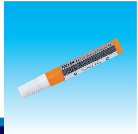
印刷途中での刷版上には、色々な傷に起因するトラブルが発生します。『アストロ PS エッチングペン』は、CTP 版や PS 版などのアルミ基材の刷版上に発生した傷を強固に形成した不感脂化被膜で簡単にカバーできます。PS 消去ペンで消去箇所を擦りすぎた場合に、アルミ基材に傷が入ったためにインキが感じてしまうという汚れが発生することがあります。汚れの発生箇所に不感脂化被膜を形成することでインキを寄せ付けなくなります。スリ傷や誤ってついた深い傷など、インキ汚れが生じるときにご使用ください。
