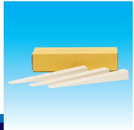
昨今の印刷はベタが多かったり、極端に絵柄が片寄っていたりと多様化しています。それにより、印刷後の用紙が不揃いになると、上がり面の印刷や後加工で時間のロスが発生してしまいます。クサビを使用することで、用紙棒積みのバランスを安定させ、給紙や排紙がスムーズに行えるようになり作業効率が上がります。用紙間に挿入しやすい形状で、抜き挿しが容易に行えるように設計しました。また、プラスチック製ですので軽くて丈夫なため、長期間の使用ができるので経済的です。
