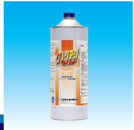
ブランケットは印刷工程の中で絶えず強い印圧を受け続けることにより、ゴム本来の弾力性を失っていきます。『クリーンアップマイルド』はブランケットのゴム表面より深部へ浸透し、弾力性を回復させると同時にインキ転移性を向上させます。強力なインキ溶解力を持ち、なおかつ素早い乾燥力で作業性が向上します。ブランケット表面の部分凹みの復元には、小さくカットしたウエスなどにしみ込ませ、凹み部分にしばらく貼付けて回復させます。
