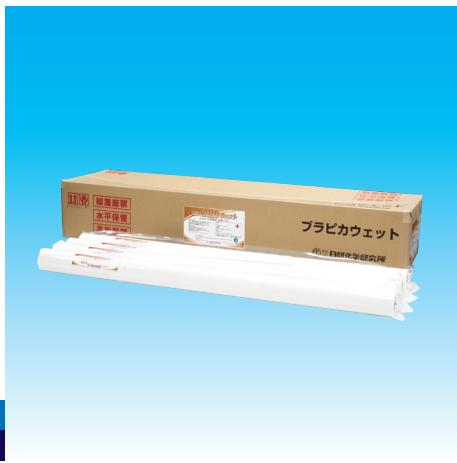
昨今洗浄布に予め洗浄剤を含浸させ、水と洗浄剤を洗浄布に噴霧する必要のないウェットタイプの使用が主流となっていました。日研化学では、洗浄剤を含浸させた洗浄布で洗浄力を強化した『ブラピカ HD ウェット』を製品化いたしました。製品本体を密封パックしてあり、含浸液の偏りや乾燥を防止する設計としました。特殊配合による含浸液は、洗浄装置へ装着後も乾燥することなく優れた洗浄力を発揮します。洗浄布表面は不織布素材と粉碎パルプの積層構造により、耐摩性に優れており毛羽立ちがありません。プランケット表面の拭残りや拭ムラなどへの対応として、含浸液量の増減した製品ラインナップや、状況に応じたサイズなどをお選びいただけます。
